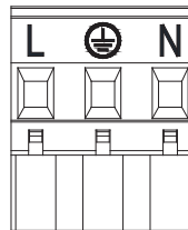
6. ábra: kivehető sorkapocs tábla a tápfeszültséghez
